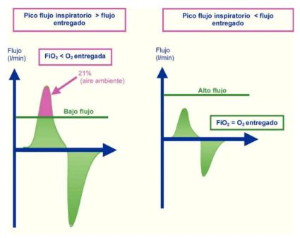
Mecanismo por el que el alto flujo obtiene mejores concentraciones de oxígeno en relación con los sistemas de bajo flujo. Figura de la izquierda con bajo flujo: el paciente obtiene aire ambiente para conseguir su pico flujo, la FiO2 obtenida es el resultado de la mezcla de aire con el oxígeno administrado. Figura de la derecha: el paciente recibe todo el aire del alto flujo, la FiO2 obtenida es igual a la entregada por el sistema de oxigenoterapia de alto flujo.
